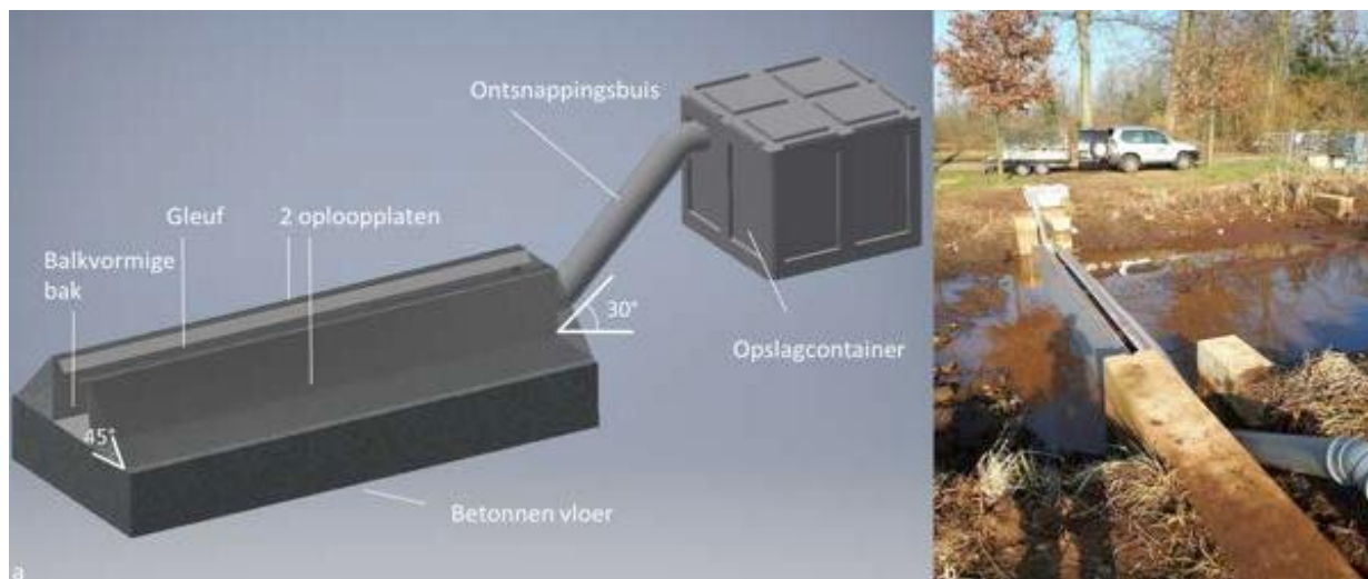
Figuur 8-54: Schematische weergave van de krabbenva (a) en plaatsing van de krabbenva op de vistrap in Grobbendonk (b) in de Kleine Nete. Voor het plaatsen van de krabbenva werd de waterstand op de vistrap tijdelijk verlaagd (Keirsebelik et al. , 2020).
