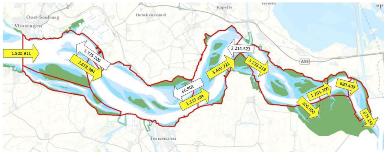
Figuur 9-469: Netto sedimenttransport (gele pijlen) in 2018 en antropogene sedimentverplaatsingen (witte pijlen) over de grens van een macrocel (Bron: Schrijver, 2020)
