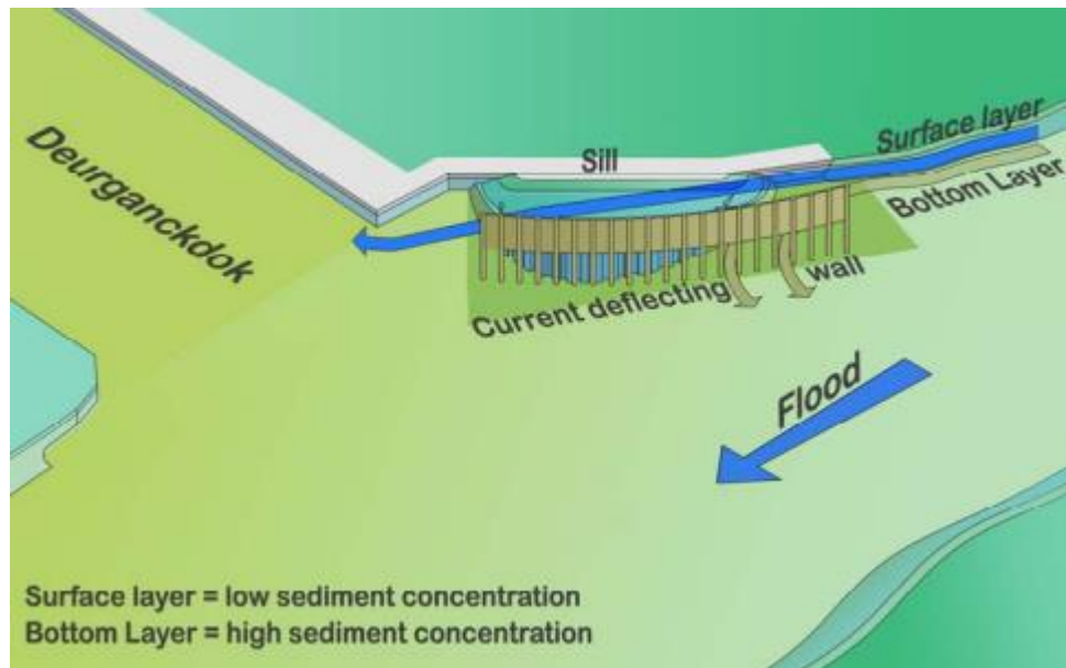
Figuur 8-27: Schematische weergave van de werking van de Current Deflecting Wall ten noorden van Deurganckdok (IMDC, 2011).
