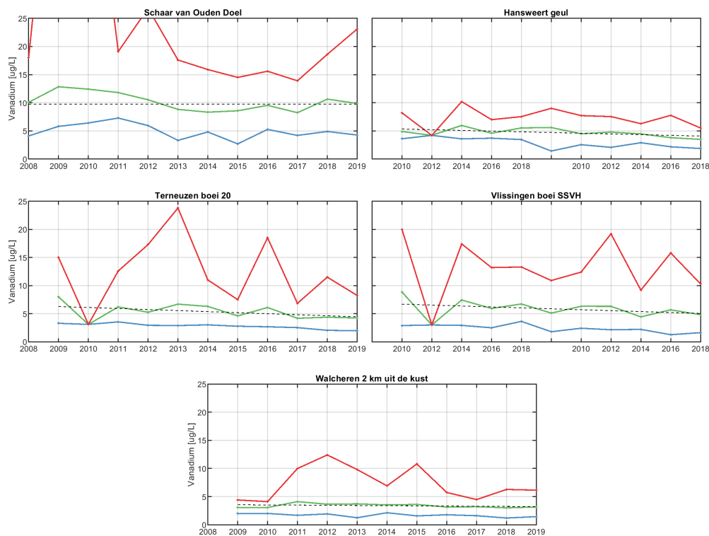
Figure 130: Jaarlijks gemiddelde, minimum en maximum van het totale vanadiumgehalte in het oppervlaktewater van de Westerschelde en de monding.
