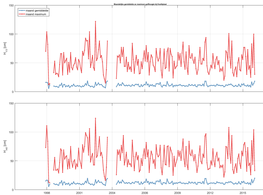
Figuur 2.34: Maandlijks gemiddelde en maximum van de significante golfhoogte H_{1/3} (boven) en H_{m0} (onder) voor station Hoofdplaat.
