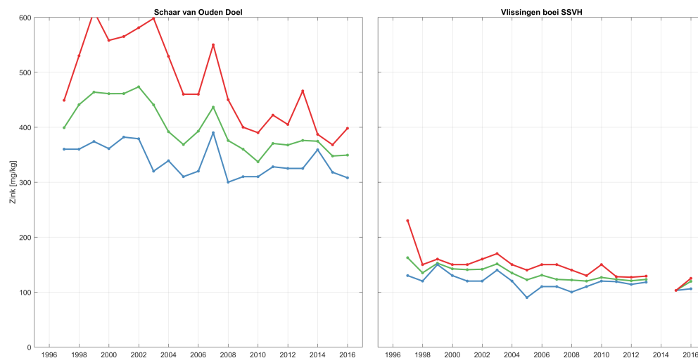
Figuur 4.12: Jaarlijks gemiddelde (groen), minimum (blauw) en maximum (rood) van de zink voor beide stations
